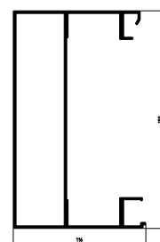
Grindă laterală cu dimensiunile de 120×190 mm
