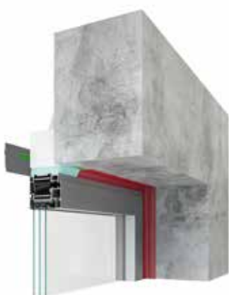
Yläliittymä, höyrynsulkuteipillä ja liimatiivisteellä
