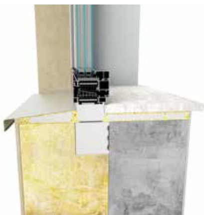
переріз вікна установка в шарі утеплення
