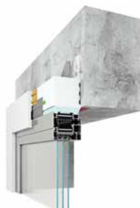
верхнє з'єднання з паронепроникною стрічкою та клеєм-ущільнювачем
