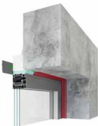
верхнє з'єднання, з застосуванням зовнішнього профілю одвірку
