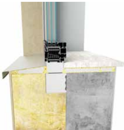
keresztmetszet a hőszigetelő rétegbe épített ablakon keresztül
