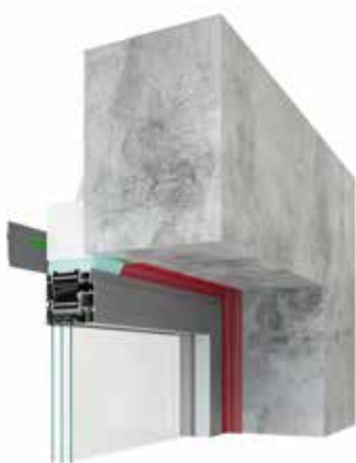
connessione traverso superiore con nastro traspirante e colla sigillante
