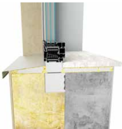
przekrój przez okno zamontowane w warstwie ocieplenia
