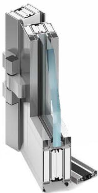
Система MB-78EI предназначена для выполнения внутренних или наружных противопожарных перегородок с одно- и двухстворчатыми дверями с классом огнестойкости EI15, EI30, EI45 или EI60, согласно нормам PN-B-02851-1:1997 и PN-EN 13501-2:2005.
