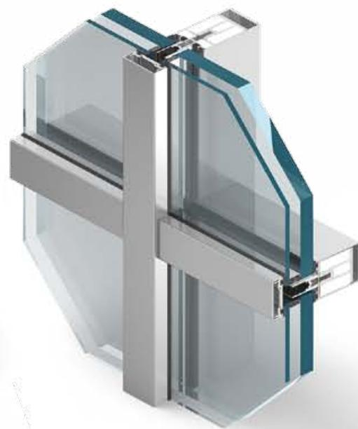
Система стоечно-ригельной стены MB-SR50 EI предназначена для выполнения легких противопожарных стен подвесного и заполняющего типа, с классом огнестойкости от EI 15 до EI 60 согласно нормы PN-EN 13501-2.
