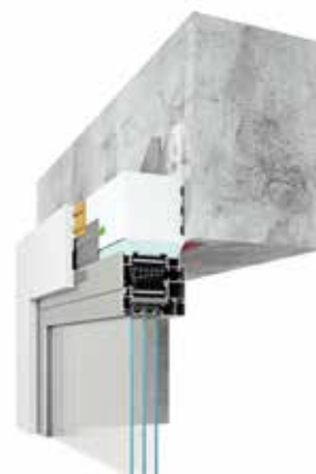
verbinding boven, met toepassing van een bovenstijlprofiel
