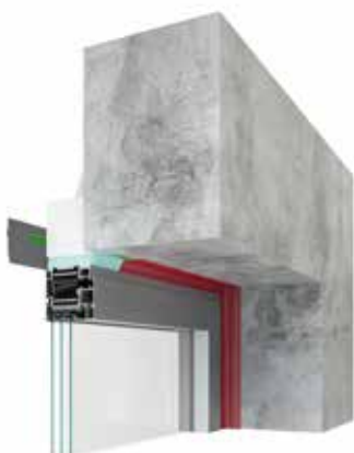
verbinding boven, met dampdicht band en lijm-afdichting
