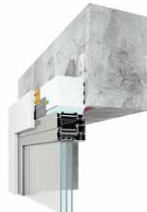
Verbindung oben, mit einem Profil mit Laibung
