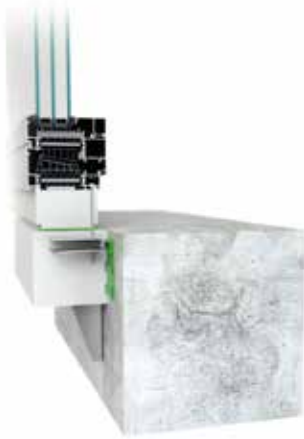
Verbindung unten, 100 mm Träger mit Außenanker
